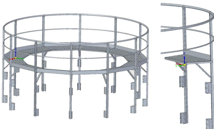
Una pasarela perimetral de acceso y mantenimiento, se coloca en la parte inferior del techo del silo.
