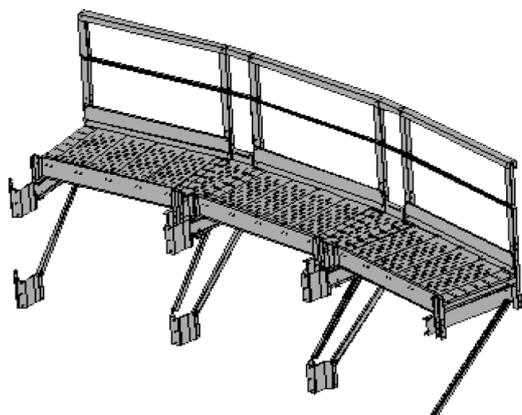
Una pasarela perimetral de acceso a techo y mantenimiento, se coloca en la parte superior del cilindro del silo e incluye piso transitable.
