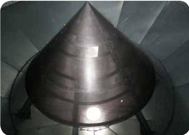
À l'intérieur, une **goulotte de déchargement** est montée pour empêcher l'amande de se casser lors de la chute et un **contre-cône entièrement perforé** avec une connexion d'entrée d'air. Ce contre-cône permet également le **chargement** du produit selon la méthode **FIFO** (premier entré, premier sorti) .
