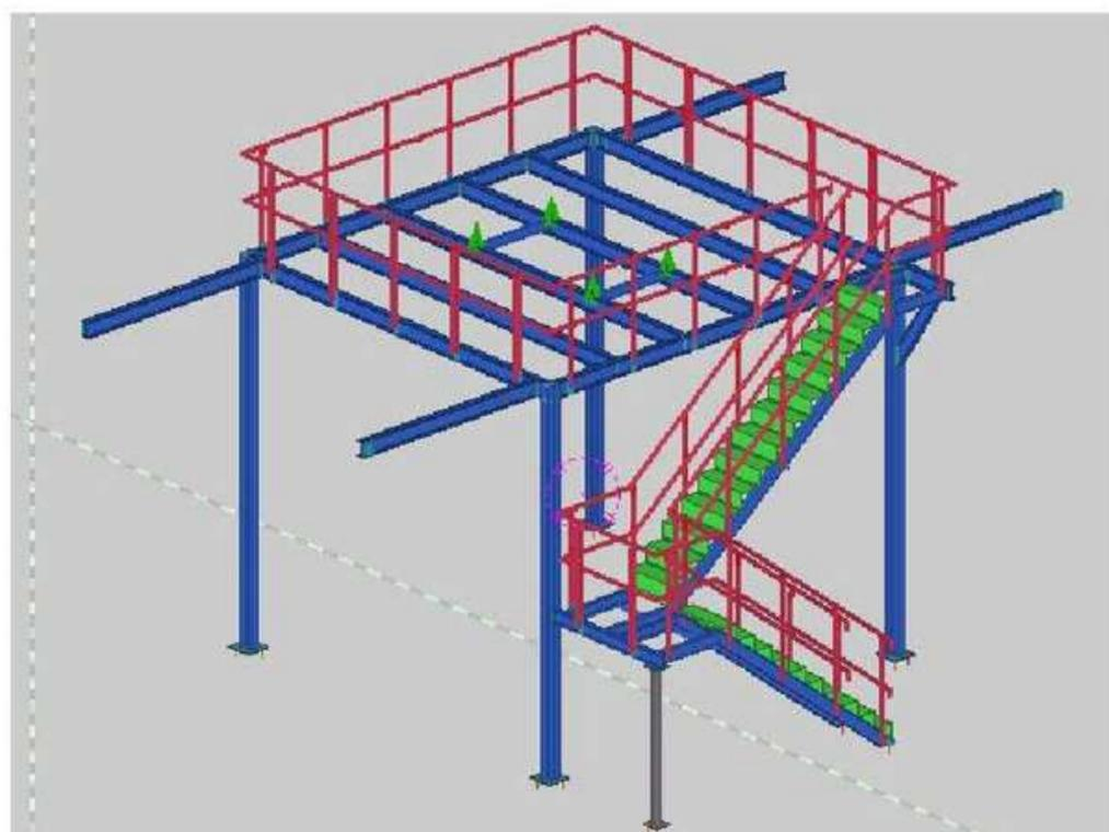
Todas las estructuras van unidas mediante tornillería calidad 8.8.
