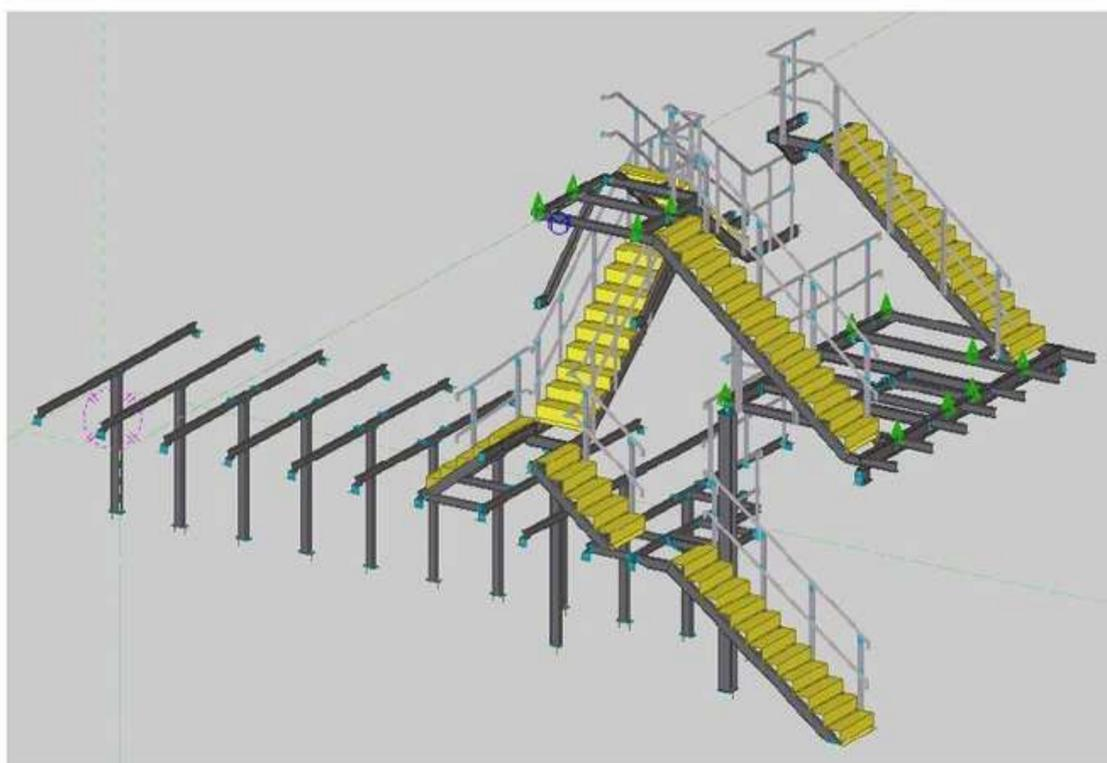
Todas las estructuras van unidas mediante tornillería calidad 8.8.
