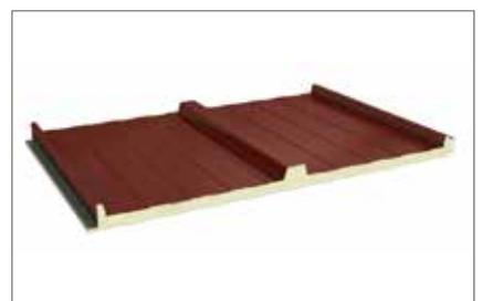
**PUR AL** ce sont des panneaux en mousse de polyuréthane avec les deux faces revêtues d'un complexe multicouche en aluminium kraft, à haute résistance thermique. La gamme comprend des épaisseurs de 20 mm à 100 mm..
