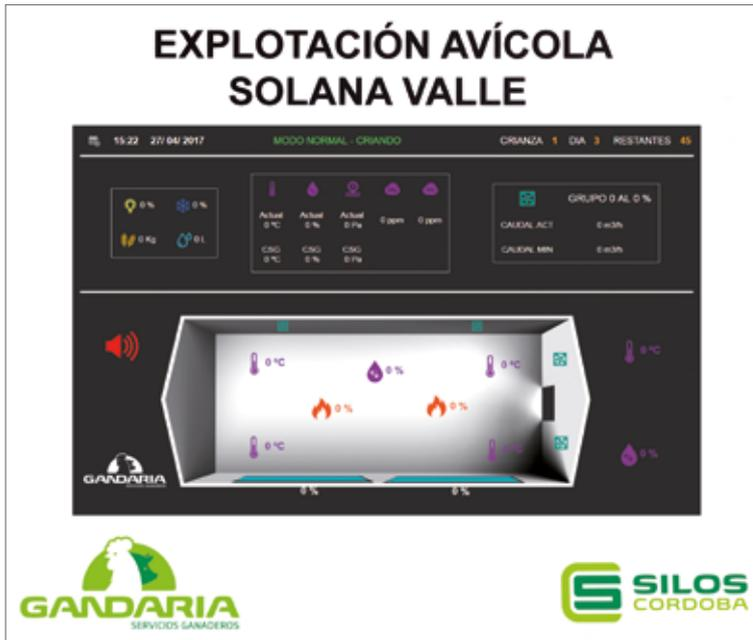
Le contrôle climatique est possible grâce à un automate de dernière génération. Occasionnellement, il peut être équipé des systèmes de captage nécessaires (sondes thermiques extérieures, intérieures, humidité CO2 et ammoniac) et remplit les fonctions avec des courbes préétablies ou variables, en fonction de l'utilisation.
