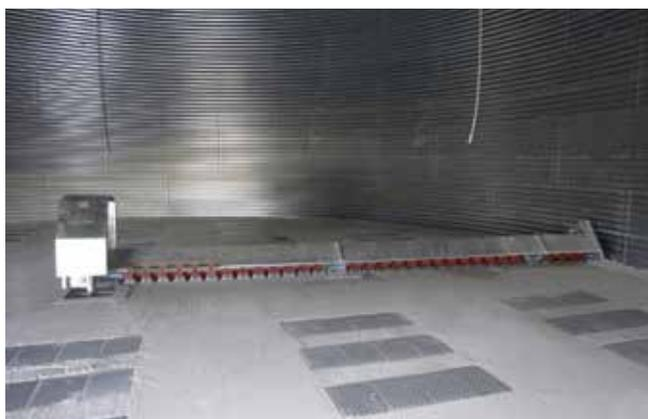
Las **barredoras** de Silos Córdoba se adaptan a todos nuestros diámetros de silo y pueden complementarse con accesorios que optimizan el vaciado eliminando todo residuo existente entre la barredora y el suelo. Cumple con la normativa ATEX para poder trabajar en el interior del silo.
