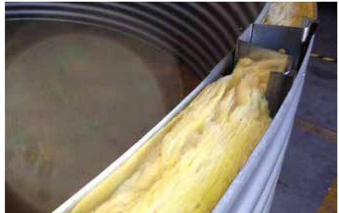
Tôle double plus matériel d'isolation : Le matériel d'isolation est ajouté entre les tôles. Les matériaux les plus habituels sont la mousse de polyuréthane et la laine de verre.
