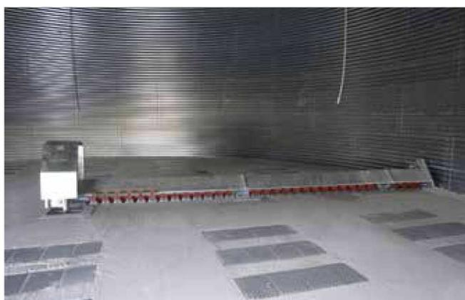
Les vis-balayeuses de Silos Spain s'adaptent à tous nos diamètres de silo et peuvent être complétées avec des accessoires pour l'optimisation du vidage moyennant l'élimination de tous les restes présents entre la balayeuse et le sol. Elles respectent les exigences de la norme ATEX relative aux opérations à réaliser à l'intérieur des silos.
