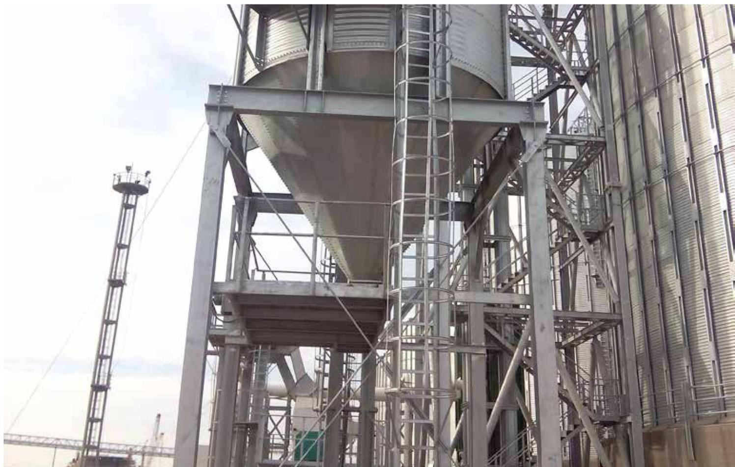
Les boisseaux de chargement sur structure ont été conçus pour le stockage et l'expédition ultérieure de produits en vrac comme les granulés, les farines, etc.
