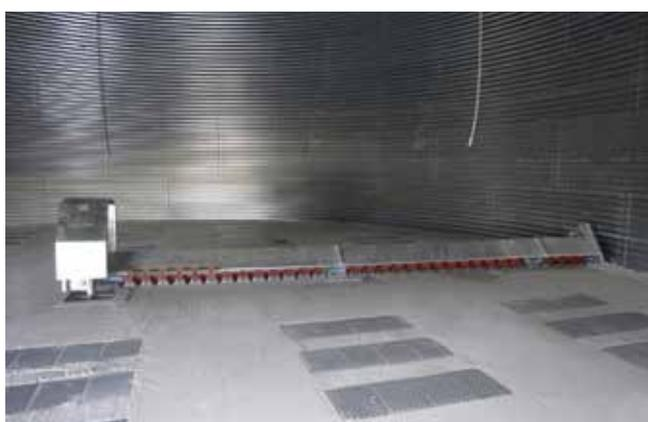
As **varredoras** dos Silos Córdoba adaptam-se a todos os nossos diâmetros de silo e podem ser complementadas com acessórios que otimizam o esvaziamento, eliminando todos os resíduos existentes entre a varredora e o solo. Cumpre a norma ATEX para poder trabalhar no interior do silo.
