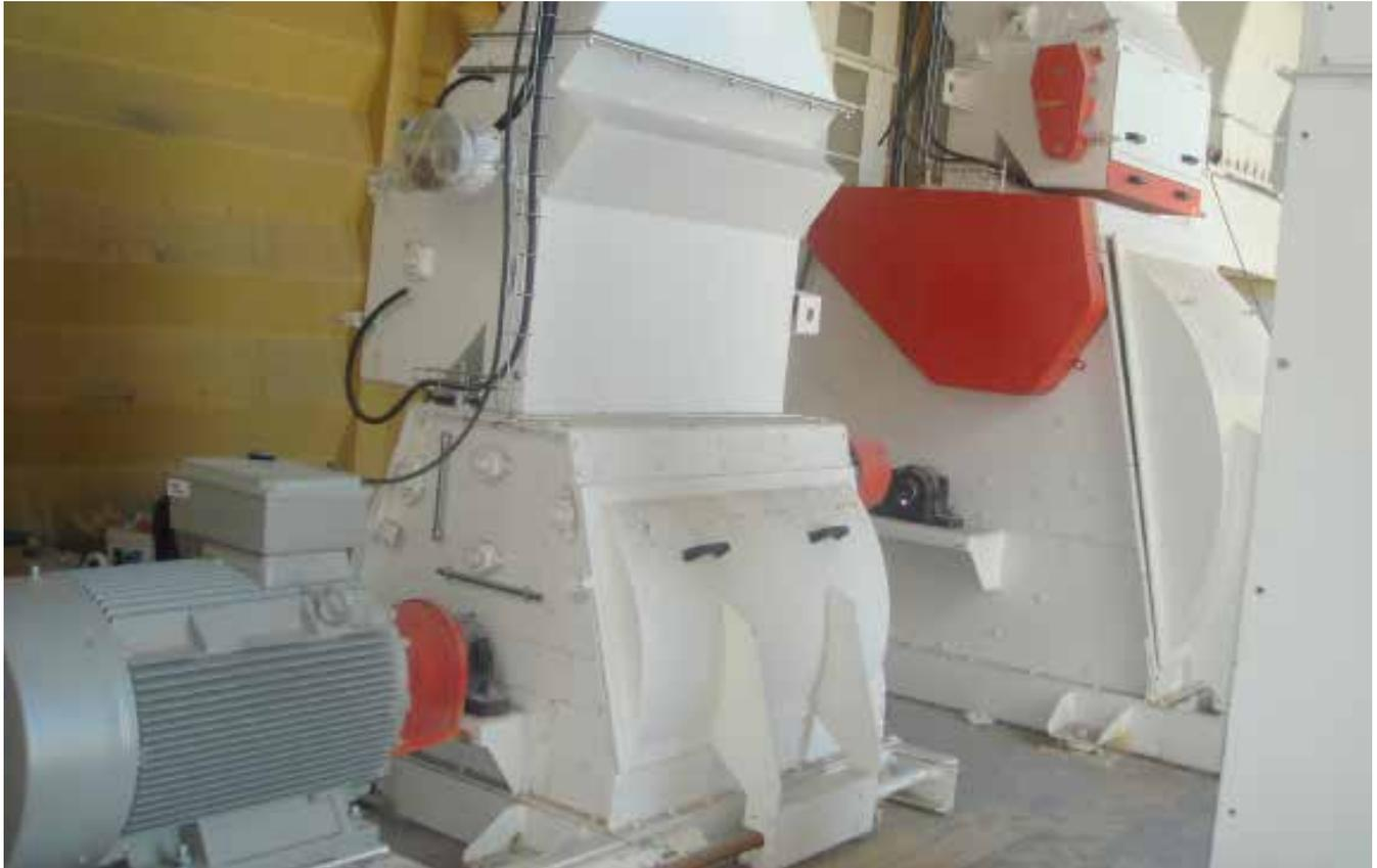
Cámara de molienda cilíndrica, determinada por una chapa perforada o criba, con orificios múltiples y abertura superior, a través de la cual se introduce el producto a moler, procedente de un depósito de alimentación situado encima del alimentador.
