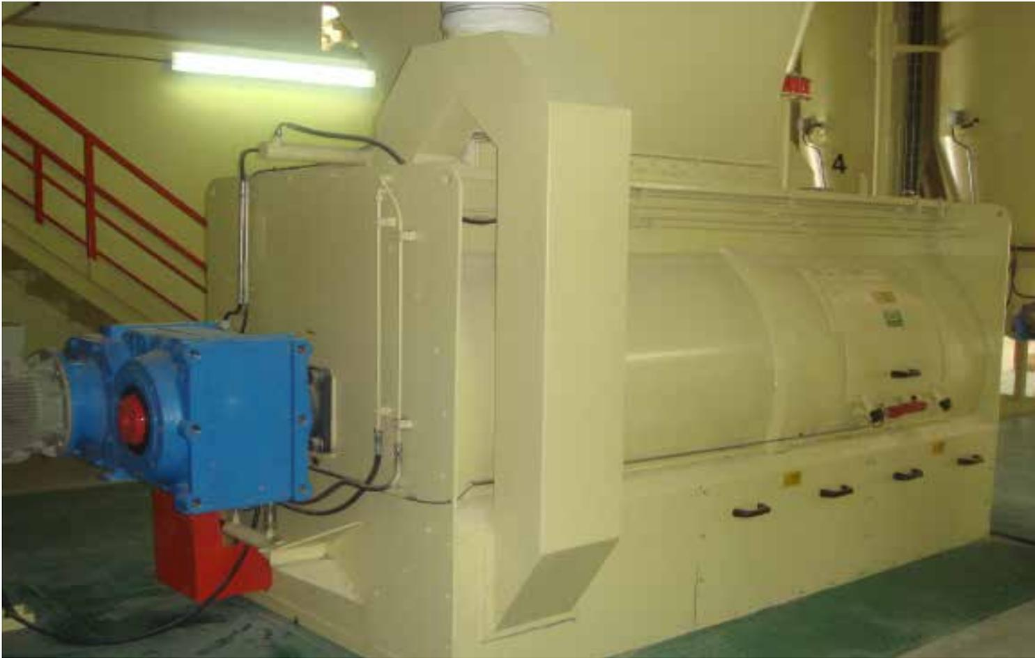
Artesa circular construida en chapa de acero de 4 mm. electro-soldada, con amplias compuertas de llenado y vaciado y parte recta para aplicación de inyectores para la incorporación de líquidos.
