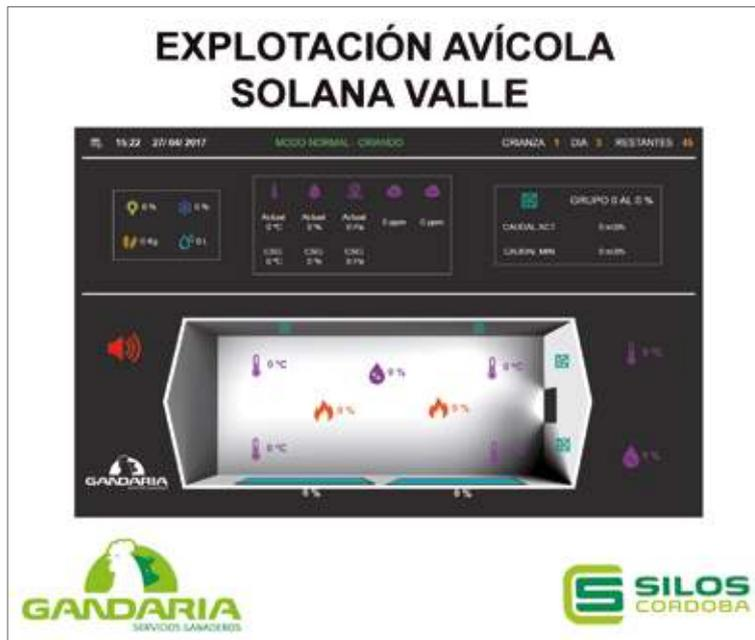
El control climático se hace mediante un autómata de última generación. Ocasionalmente dispone de los sistemas necesarios de captación (sondas de temperatura exterior, interior, humedad, CO<sub>2</sub> y amoníaco) y realiza las funciones con curvas prefijadas o variables según manejo.
